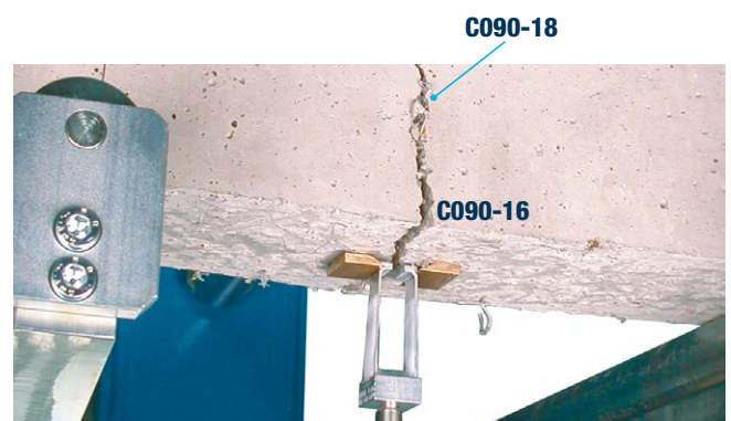
EN 14651 Clip gauge device
